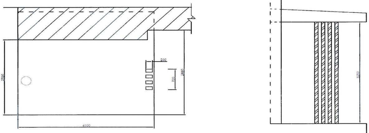
Рис.3 План козырька и ж/б столбы
